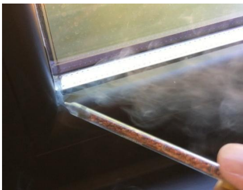
Contrôle d'étanchéité à l'air
